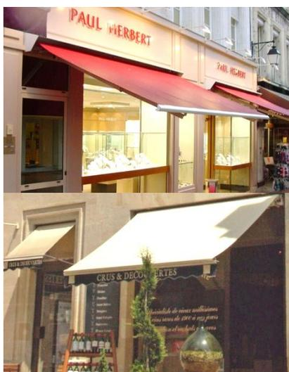
La bannière est développée par un système discret de bras articulés installés sous le coffre de devanture.
